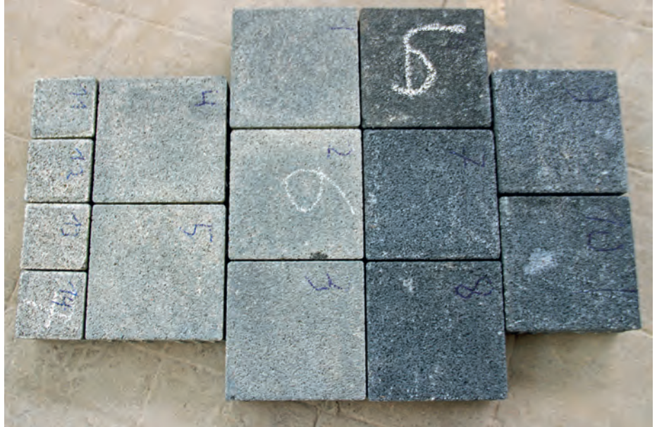
7. Betonpflastersteine mit einer massiven Aufhellung (im li.).
