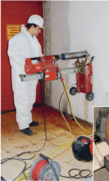
Bild 5: Entnahme von Bohrkernen
