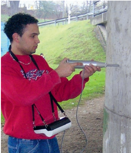
Bild 2: Rückpralluntersuchung an Bauwerksbeton (indirektes Prüfverfahren)
