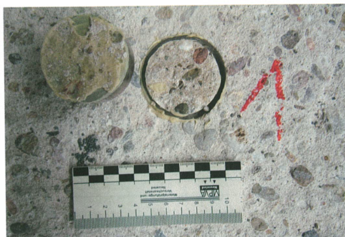
Bild 8: Abriebbilder im Kleber (links) und im Beton (rechts)
