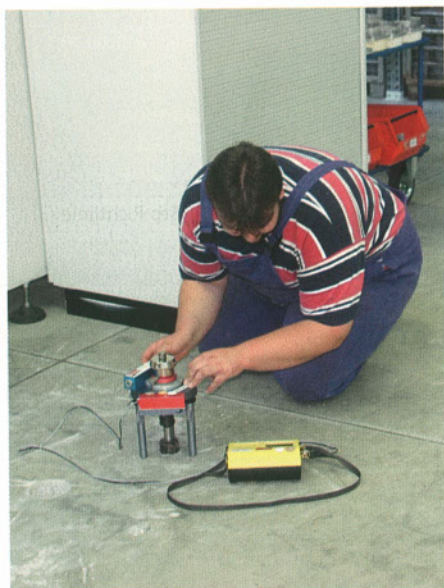
Bild 1: Bestimmung der Oberflächenzugfestigkeit an einer Bodenfläche mittels Kurbelgerät
