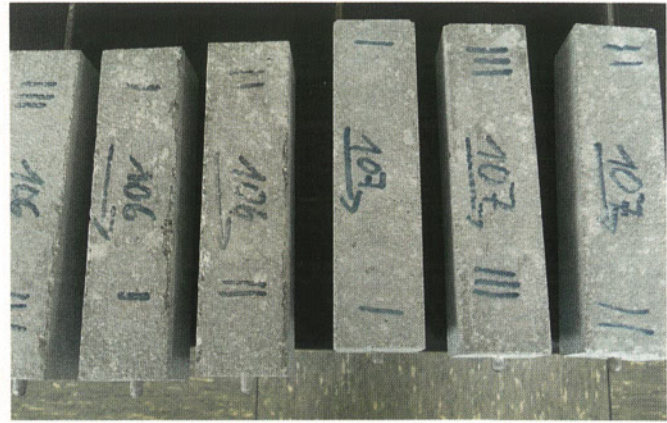
Abb. 7: Mörtelprismen nach der Natronlaugenlagerung entsprechend dem Schnellverfahren nach Teil 3 der Alkali-Richtlinie [5]
