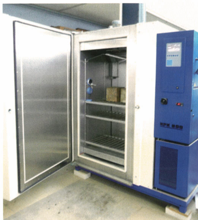
Abb. 8: Nebelkammer-Verfahren nach Teil 3 der Alkali-Richtlinie [5]
