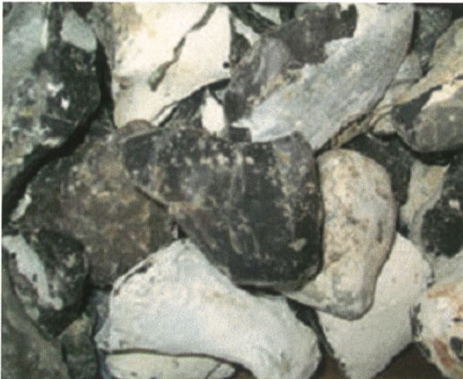
Abb. 4: Potentiell alkaliempfindliche Gesteinskörnung gemäß Teil 2 der Alkali-Richtlinie
