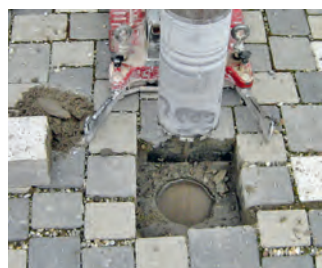
2. Erscheinungsbild des Bettungsmörtels im Rahmen der Probenahme.
