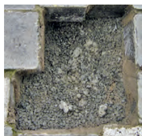
2. Erscheinungsbild des Bettungsmörtels im Rahmen der Probenahme.
